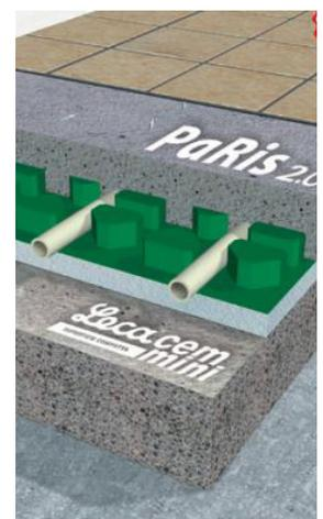
Stratigrafia massetti di sottofondo la pavimentazione
